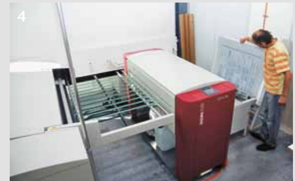
Die CTP-Anlage (Computer-to-Plate) erstellt die fertige Druckplatte
